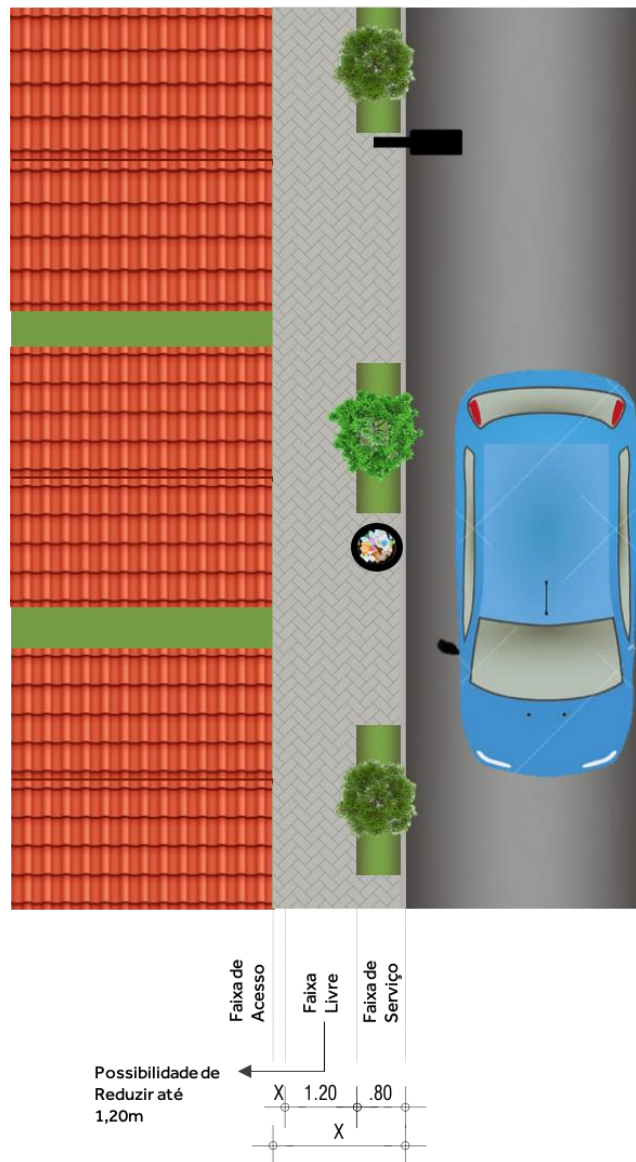
Figura 2 – Padrão de calçada com largura superior a 2,00m e inferior a 2,30m.
